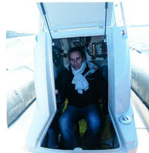
La console peut abriter un WC optionnel. L'ouverture frontale est facilitée par deux vérins à gaz, et la porte dispose d'une fermeture à clé.
