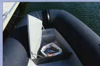
La baïlle à mouillage est optionnelle mais bien pratique. Un vaste rangement est accessible en levant la façade avant de la console.
