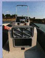
Un coffre est accessible sur l'arrière de l'assise leaning-post. Le vivier, lui, est situé sous le plancher du cockpit.
